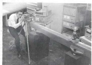
d'un objectif de microscope (travaillant à l'envers) pour en former une image sur le film dont on veut déterminer le pouvoir séparateur linéaire (on arrive ainsi à compter sur le film, 500 à 600 lignes par mm ; à titre indicatif, les films noir et blanc, du type PLUS X, utilisés en photographie d'amateur, permettent de résoudre 60 à 80 lignes par mm).
